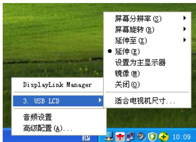
3. 选中下列菜单中的参数显示或设置项，点击对 USB 显示器进行相应的设置或显示 USB 显示器的当前参数。
