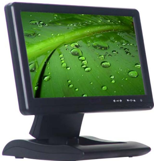
USB 显示器就是一个 USB 外部设备，和一般的显示器需要连接电源线和 VGA 线不同，小尺寸的 USB 显示器只需要一根 USB 线和电脑连接就可以工作。和常见的摄像头类似，其工作所需要的电能和图形信号的传输都是由 USB 线完成。本 USB 显示器是一款较大尺寸的 USB 显示器，并且带有触摸功能、亮度调整及音频监听功能，通过 USB 线，用户就可以把本产品做为扩展显示器及音频监听使用。但因为功能较多，如果单独由 USB 供电，有可能产生电能不足的现象，所以，客户如果发现本机无法正常工作，可以通过本产品的辅助电源输入，输入 5V 直流电源。
