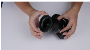
根据镜头规格取相应的 转接环安装于镜头上
