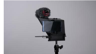
把组装好的套件安装在脚架上， 提词器顶部的冷靴座可安装麦克 风、补光灯等
