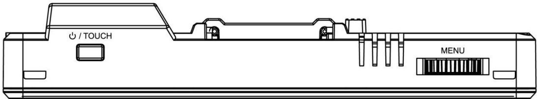
**SH / TOUCH**：长按为开关机；短按打开、关闭屏幕触摸功能。
