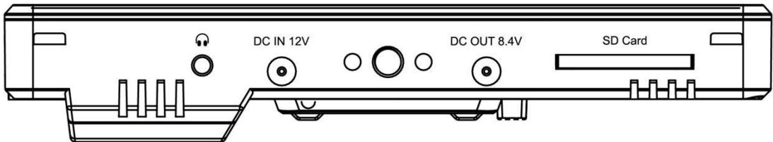
**耳机**：3.5mm 立体声耳机输出端口
