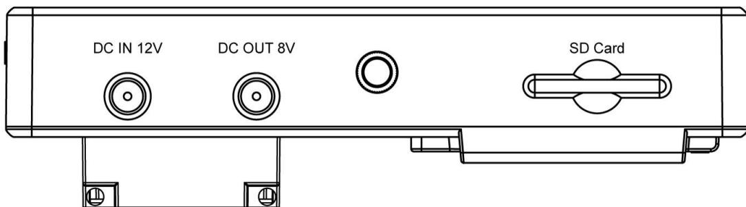
**DC IN 12V:** 电源输入端口，输入极性为
