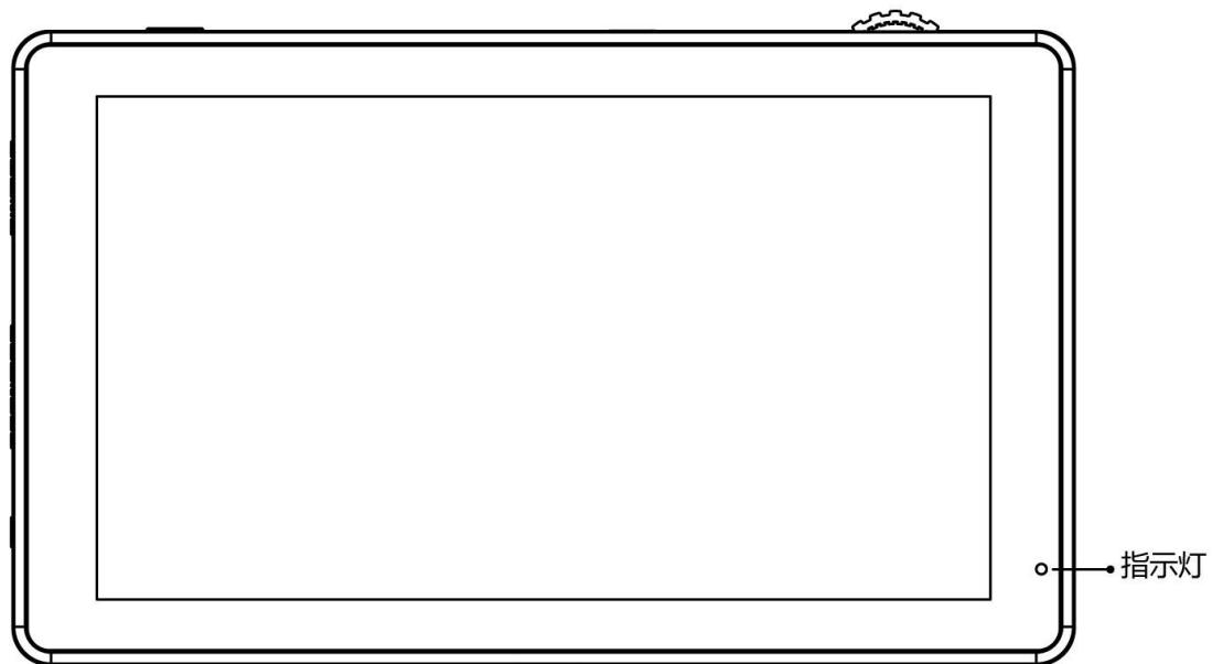
**指示灯:** 正确接入电源后指示灯亮（红色），长按左侧  $\downarrow$  / TOUCH 键开机，指示灯转为黄色，接入信号后，指示灯转为绿色。
