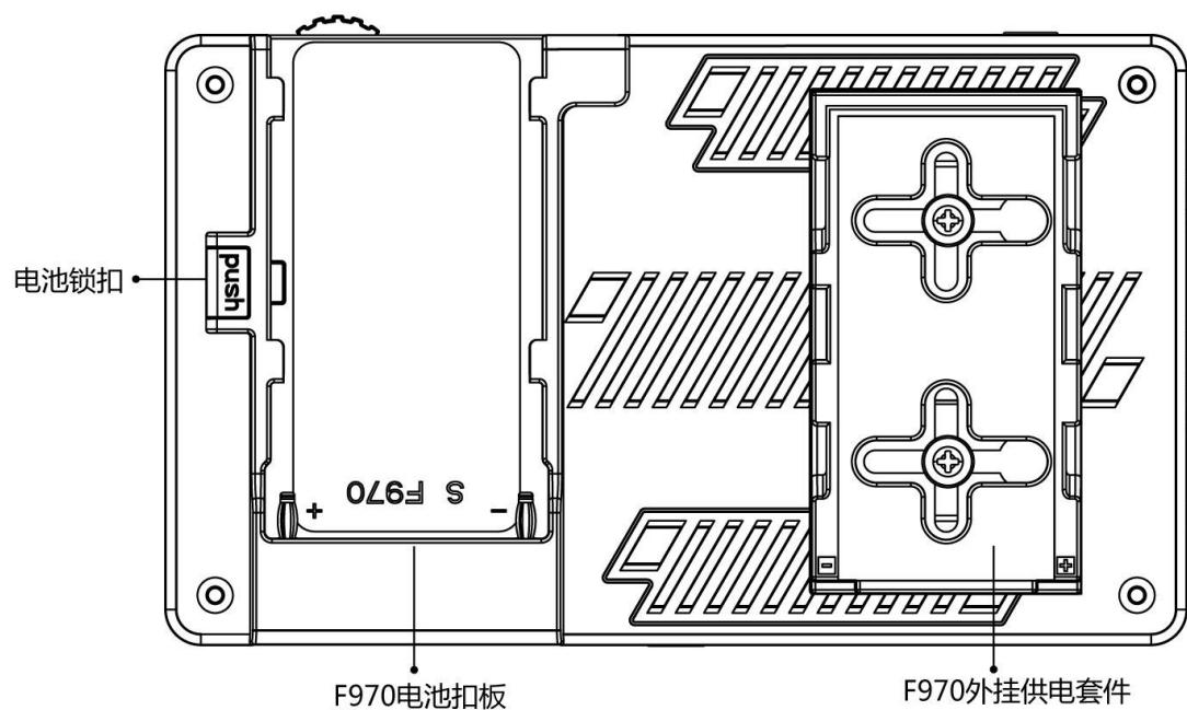
**电池锁扣**：电池装上后锁扣会锁住，取下电池前请先按 **PUSH**。
