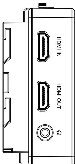
**HDMI IN:** HDMI V1.4 , 最高支持 4K@30 信号输入
