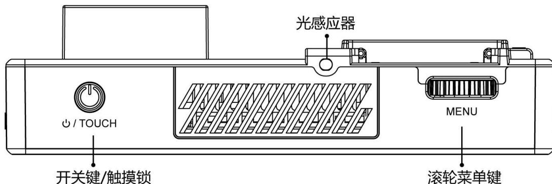
**电源 / TOUCH**（开关键/触摸锁）：长按为开关机；短按打开、关闭
