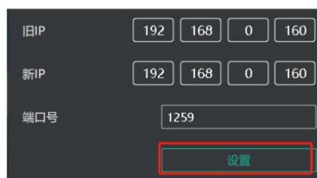
1. 在 PTZ 摄像头设置相应的通讯端口，如 Visca 或 UDP 端口 1259，设置完之后，点击保存按钮使配置生效。
