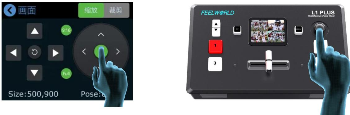
(5) 设置完抠图后，参数可以直接保存在设备上，下次使用，无论是上位机、包括手机还是下位机打开抠图，都可以直接打开上次保存的参数设置。
