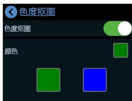
(3) 选择颜色并进行调整，默认的颜色是绿色背景。您可对抠图参数进行更详细的设置和调整，设备默认参数为：上限 1232，下限 560，边缘 602。
