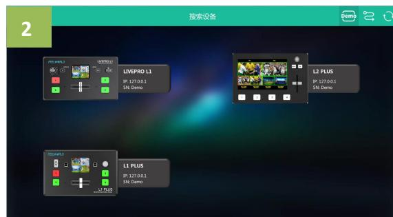
2. 搜索后，会显示出目前连入同一个局域网内所有的相同的设备，最多可搜索到 128 台设备。
