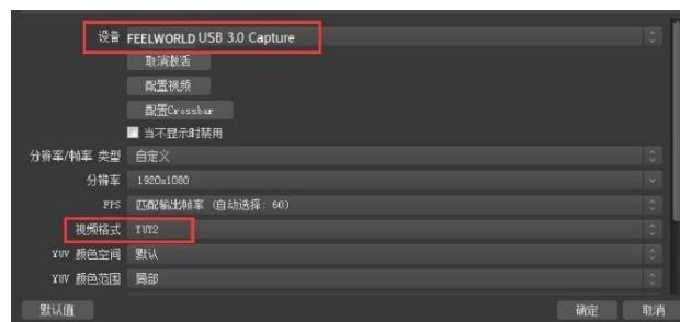
**注：**打开 OBS，按照图示步骤进行设置，若视频格式处未出现 YUY2 选项，需确认 L1 PLUS 的 USB 3.0 的是否正确接到电脑主机后的 USB 3.0 口上（USB 3.0 接口为蓝色），是否使用了非 USB 3.0 的线材。如采集画面闪，把视频格式设置成 YUY2。
