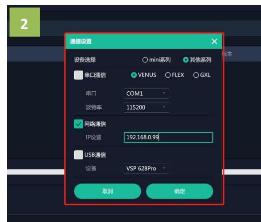
2. 输入 L1 PLUS 设备的 IP 地址后，点击确定。
