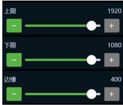
(4) 调用完抠图后，进入画面调整界面，如下图所示。在画面调整界面，您可以通过轻触触摸屏右侧中心位置的 A/B 或轻按摇杆的方式进行主/子图层信号的选择，通过轻按①②③④信号源选择您需要的主/子信号，通过上下按键调整画面的大小，通过摇杆调整画面的位置。您还可以直接点击 9:16 或 Full 直接将 A/B 图层的比例调整为 9:16 或全屏。
