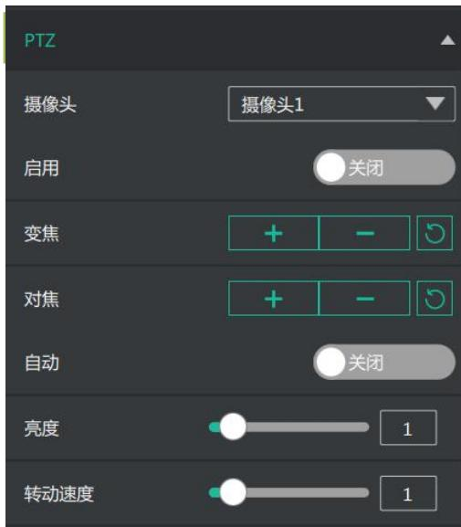
3. IP 地址设置完成后，打开“启用”即可对所选的 PTZ 摄像头进行控制。
