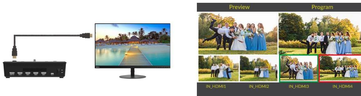
HDMI 输出除了支持多画面监看外，还支持选择固定输出某一路输入信号或者直接选择主输出的信号，您可以通过菜单里面的输出设置进行 **PVW** 和 **PGM** 的切换与各个输入信号之间的切换。
