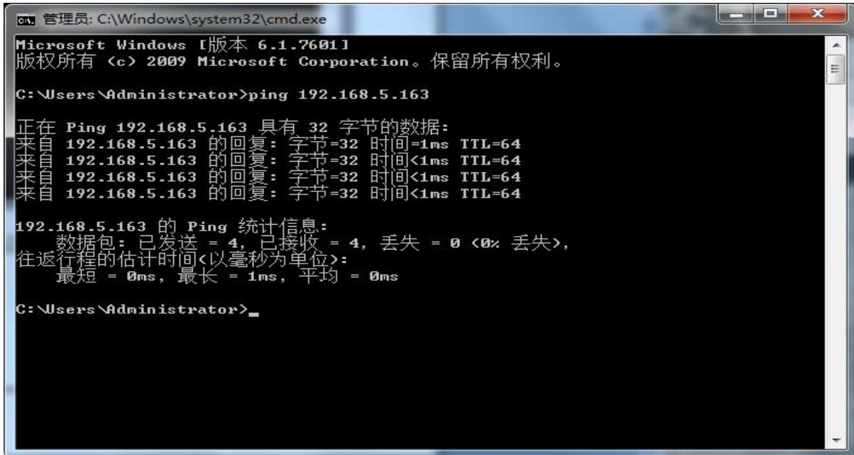
图 4-2 网络连接正常示意图
