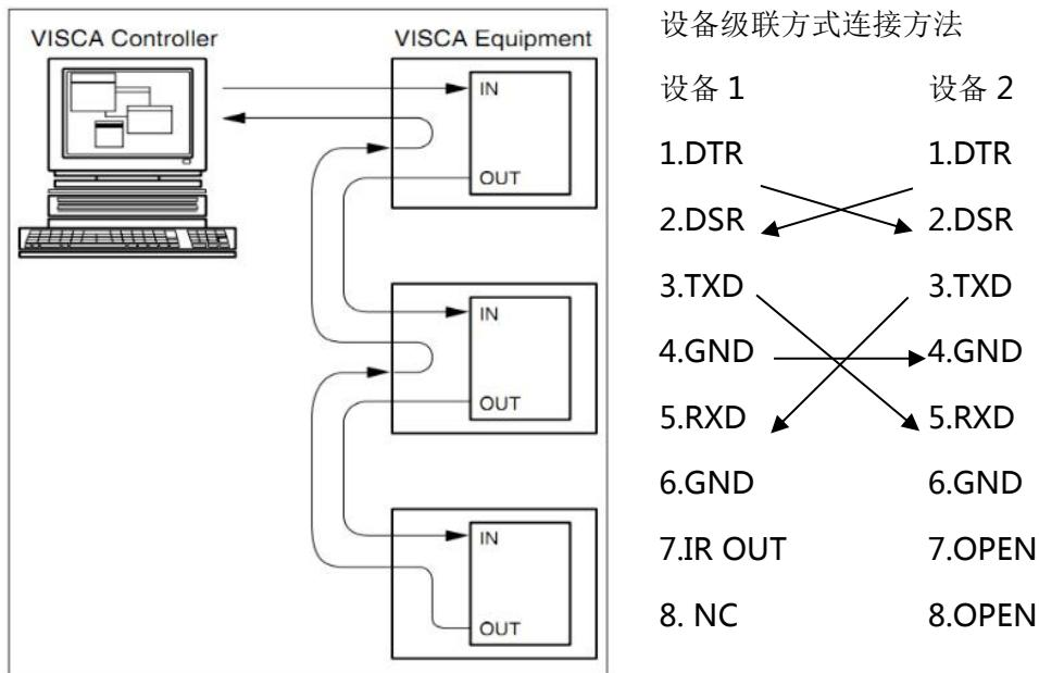
图 2-4 VISCA 组网方式示意图
