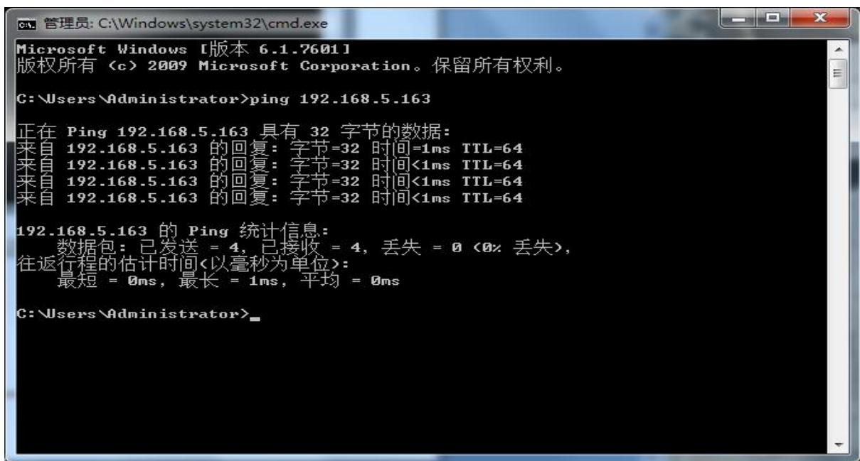
图 4-2 网络连接正常示意图
