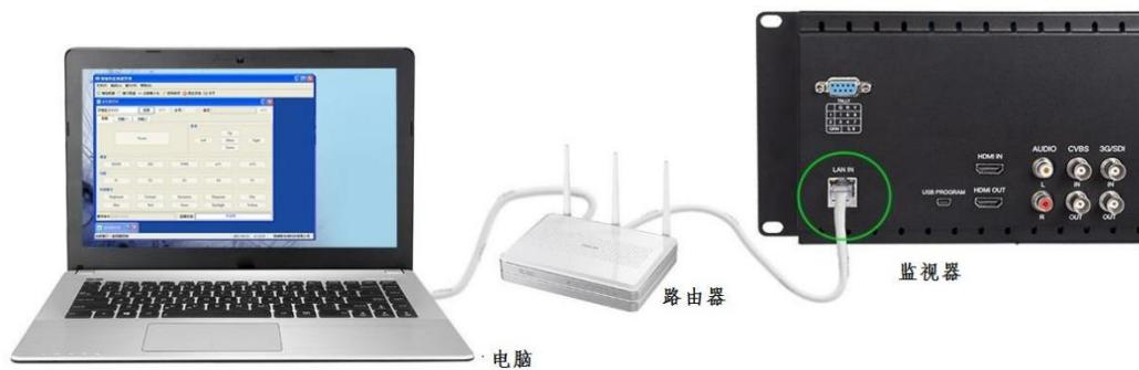
将监视器后面板的 LAN 端口连接到局域网。连接后，监视器将显示该设备的 IP 地址。
