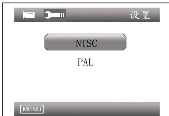
备注：如果在设置 TV 输出制式后发生图像画面不能同步，甚至 DVR 的菜单也无法调出时，系 DVR 的输出制式与监视器的制式不同步所致，如果发生此现象时，可从调出监视器的菜单，进入菜单中的“功能”设置中“制式”进行相应的制式选择。
