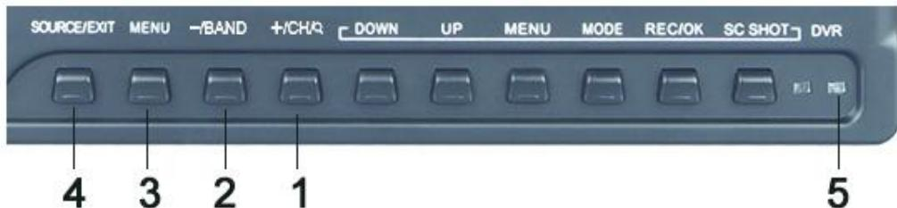
1. **+/CH/Q**：复用键，为频道选择/自动搜索/音量加大/向上选择。机器在工作状态下无显示菜单时，直接点击按键时为频道选择，长按此键，进入频道自动搜索。在音量调整为音量加大。在菜单操作中，屏幕显示菜单时，此键作为菜单项目选择，在子菜单调整项确定后，此键作为调整项的数值增加或调整项的选择。
