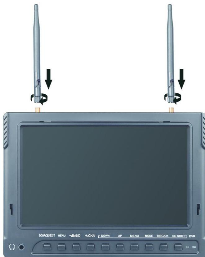
将配套的天线装配上主机的天线输入端口，装配时要牢靠，上紧锁扣。
