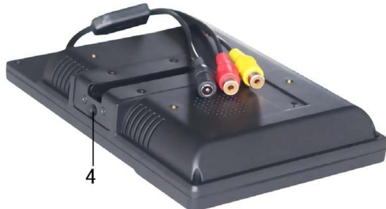
1. 黑色直流电源 12V 输入端口，芯+ 外-
