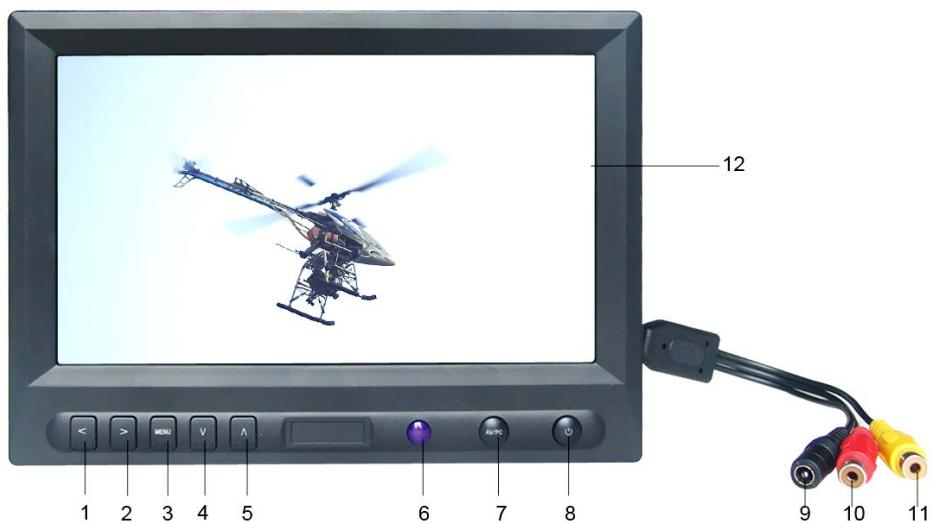
1. < : 音量减, 直接按此键控制音量的减小, 菜单中用于设定值的调整
