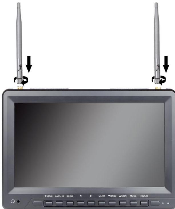
将配套的天线装配上主机的天线输入端口，装配时要牢靠，上紧锁扣。
