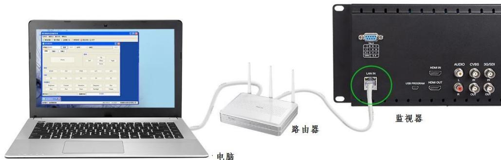
将监视器后面板的 LAN 端口连接到局域网。连接后，监视器将显示该设备的 IP 地址。
